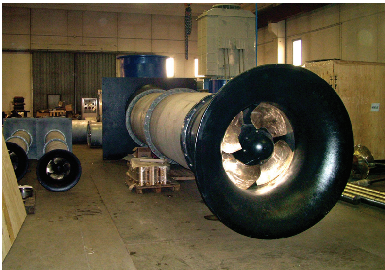
Particolare della pompa da 4 mc/s prima del collaudo in officina della Meregalli di Monza nel 2005
